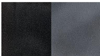
Struttura esterna in nylon (PA) ed interno in poliestere resinato (PL).
