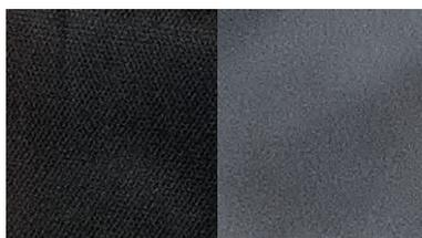
Struttura esterna in nylon (PA) isolamento in poliuretano espanso (PU) ed interno in poliestere resinato (PL).
