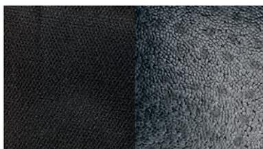
La struttura interna in Polipropilene espanso (PPE) garantisce la miglior tenuta isotermica della categoria.
